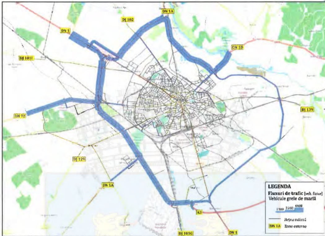
Figura 3.17. Fluxuri de trafic, autovehicule grele de marfă, MZA 2021.
