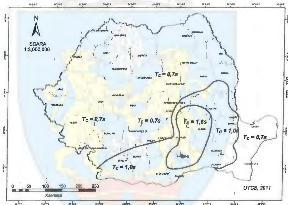
Fig. 4 Zonarea teritoriului Romaniei in termeni de perioada de control (colt), T_c a spectrului de raspuns, conform P100-1/2013 „Cod de proiectare seismica”
