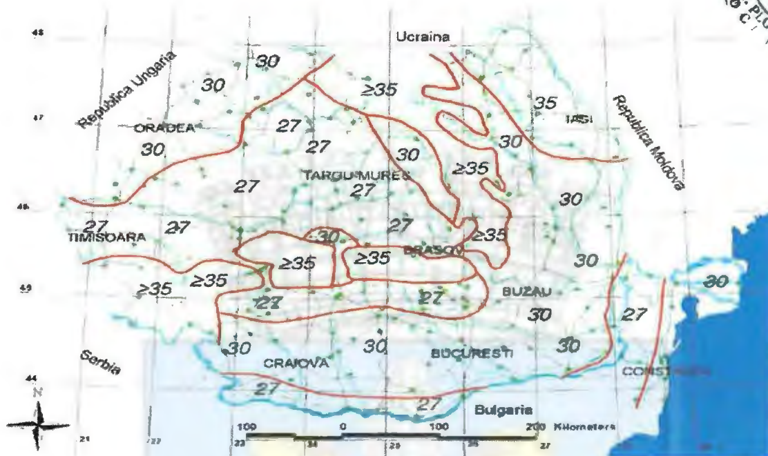
Fig. 6: Harta de zonare a valorii fundamentale a vitezei de referință a vântului, v_{b,0}
