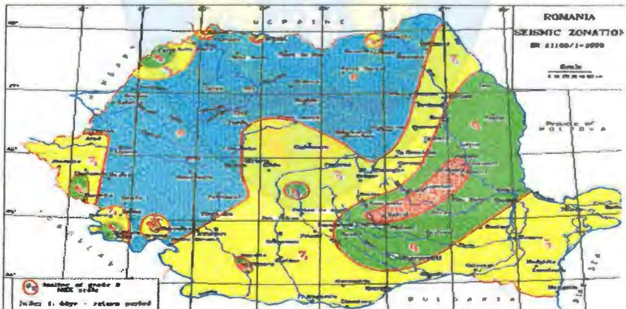
Fig. 3: Harta de zonare a intensității seismice (conf. STAS 11100/1-93)
